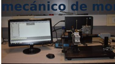
El Laboratorio de Ingeniería de la Construcción (LabIC.UGR) cuenta con un equipo de DMA (Dynamic Mechanical Analyzer) que permite la evaluación mecánica de morteros bituminosos y materiales polímericos. De este modo, es posible estudiar la interacción entre distintos tipos de ligante con la fracción más fina de los áridos de la mezcla y la influencia del empleo de distintos tipos de fíller y aditivos.
