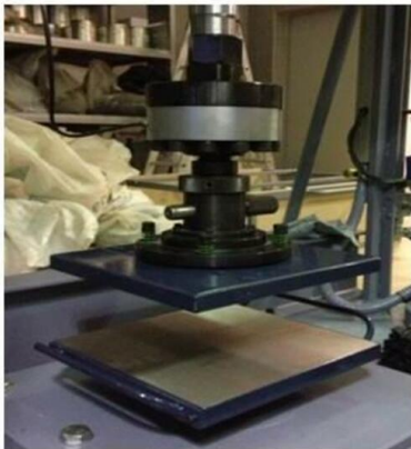
Dispositivo para ensayos estáticos y dinámico de mantas
